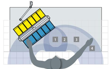
Optimale Anordnung der Greifbehälter in den Zonen 2 und 3 direkt neben dem Werkstück
